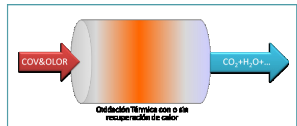
Figura 1. Principio funcionamiento oxidación térmica
