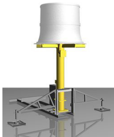
Figura 1 Aerogenerador EOLAGE para la dispersión de emisiones
